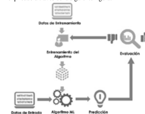
Figura 3. Proceso de implementación de un modelo de Machine Learning.
